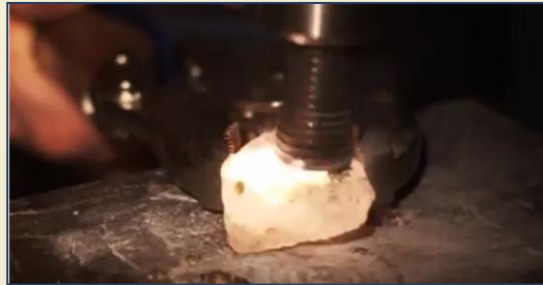
Lampo di luce in un cristallo di quarzo durante la lavorazione meccanica mediante fresatura.
